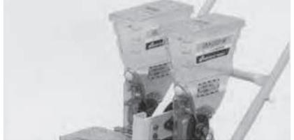
粒状農薬を播種と同時に散布する装置です。
