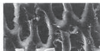
ハイプロの電子顕微鏡写真(×700)
